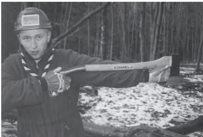
primerna dolžina toporišča sekire
